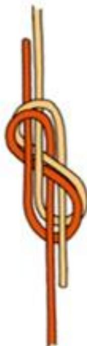
Často používaný spojovací uzel. Hodi se však jen pro spojení konců lana stejného průměru, nebo popruhů stejně šíře. Uzel nejeví žádné tendence k samovolnému rozvazování, snad jedině při extrémně silném a v nevhodném směru vedeném tření o skálu je možné, že by se rozvázel. Po silném zatižení jde relativně dobře rozvázat.
